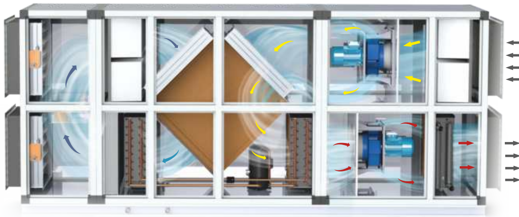
Схема распределения воздуха в агрегате климатической серии «ATLANTIS»
